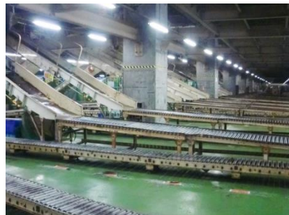
トラックへの積荷を行うためのレーン
