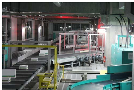
荷物をスキャンし、輸送地方ごとに振り分けるスパイラルコンベア
